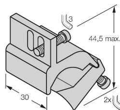
Soporte de montaje para el montaje de sensores de campo magnético en cilindros de tirantes; diámetro del cilindro: 50...125 mm; material: Aluminio
