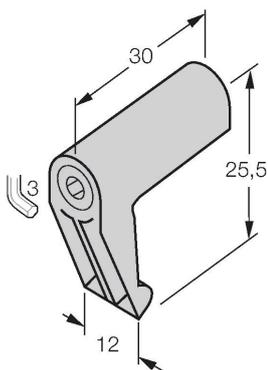
Soporte de montaje para el montaje de sensores de campo magnético en cilindros de tirantes; diámetro del cilindro: 32...100 mm; material: Fundición inyectada de zinc
