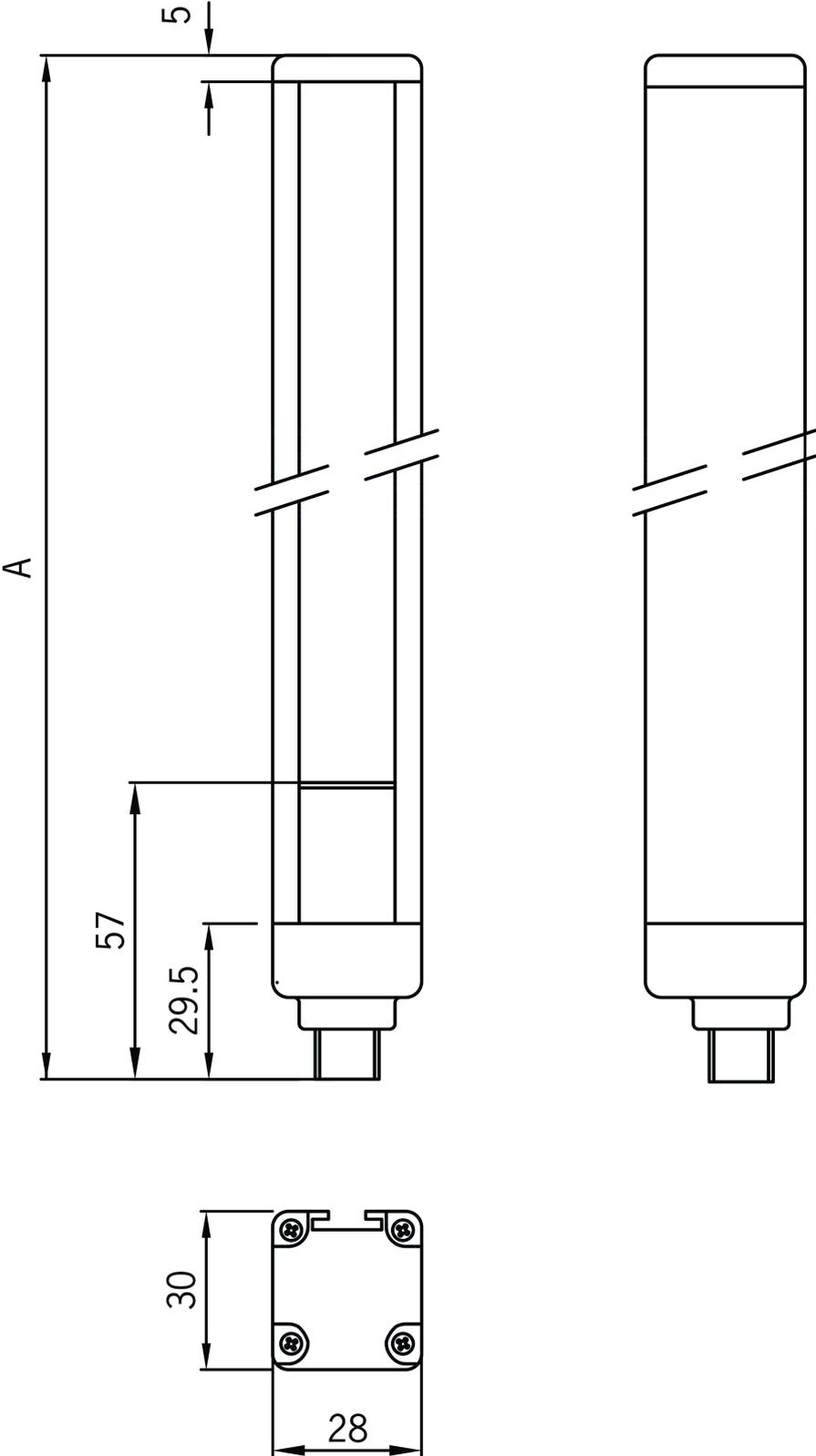
A = Altura del sensor (véanse los datos técnicos)
